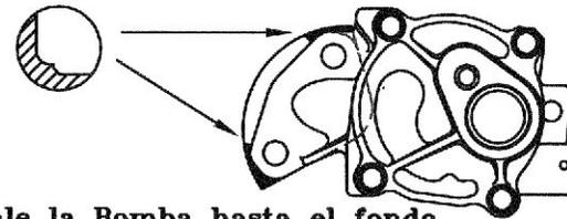
Instale la Bomba hasta el fondo y dele vuelta un poco para asegurar contacto de la Bomba y la base donde sera instalada.
